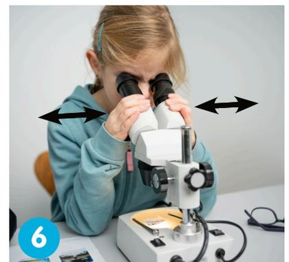
**6** Nun schaust du mit beiden Augen durch die Binokularlupe und passt die beiden Okulare an deinen Augenabstand an. Bei richtiger Einstellung siehst du ein scharfes, kreisrundes Bild.
