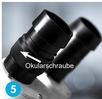
**5** Schau jetzt nur mit dem linken Auge durch das linke Okular und stelle mit der Okularschraube das Bild wieder scharf.
