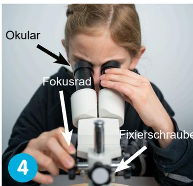
**4** Schau durch das rechte Okular und stelle das Bild mit dem Fokusrad scharf. Sollte das unmöglich sein, so passe die Höheneinstellung vorsichtig mit der Fixierschraube an.
