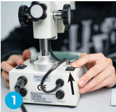
**1** Verbinde das Stromkabel mit der Steckdose und schalte die Binokularlupe ein.
