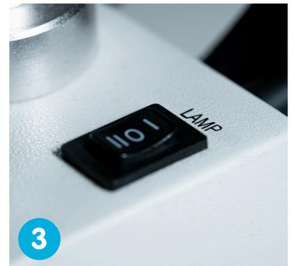
**3** Mit dem Schalter "LAMP" wechselst du zwischen Durchlicht und Auflicht. **Vorsicht:** Die Lampen werden heiss!
