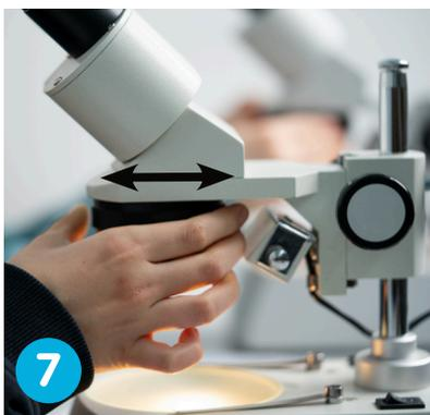
**7** Mit dem Objektivrevolver passt du die Vergrößerung an. Starte mit 10-fach Vergrößerung, probiere danach die 30-fach-Vergrößerung aus.
