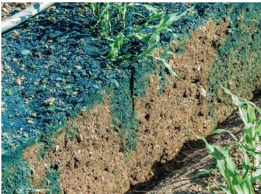
*Infiltrationsversuch in einem Maisfeld. Mit Lebensmittelfarbe eingefärbtes Wasser wird gleichmässig auf die Bodenoberfläche gegeben. In den Grobporen versickert das Wasser relativ rasch. Im Bereich der Pflanzen dienen die Wurzelkanäle als Transportroute in die Tiefe. Links neben den Pflanzen befindet sich eine Fahrspur, in der die Versickerung infolge Verdichtung gehemmt ist.*
